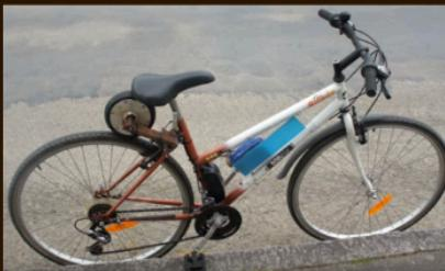
Exemple de vélo à assistance électrique construit avec un moteur d'hoverboard
